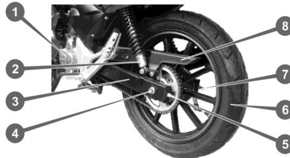
Рисунок 14 – Ланцюгова передача і маятникова підвіска
