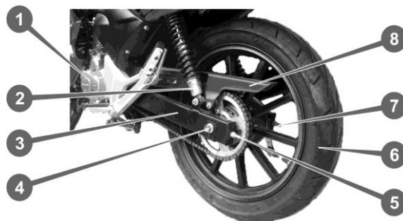
Рисунок 18 – Ланцюгова передача і маятникова підвіска
