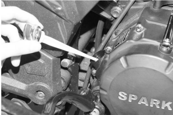
Рисунок 6.1. Пробка-щуп мастила картера двигуна
