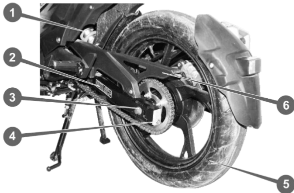
Рисунок 6.6. Ланцюгова передача і маятникова підвіска
