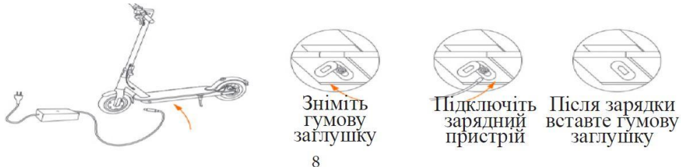
Рисунок 6. Схема зарядки батареї електросамокату.
